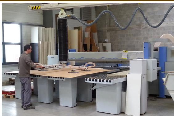
Vous manipulez des panneaux pouvant atteindre 250 KG pour alimenter votre scie à panneaux horizontale ? Nos systèmes à ventouses MANUT-LM permettent à un seul opérateur de manipuler vos panneaux en supprimant la pénibilité sur le poste de travail.
