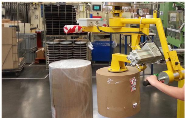
Vous manipulez des bobines avec basculement ou non pour alimenter une machine, un convoyeur ou une palette ? Nos solutions d'aide à la manutention permettent d'effectuer ces opérations en protégeant l'opérateur.
