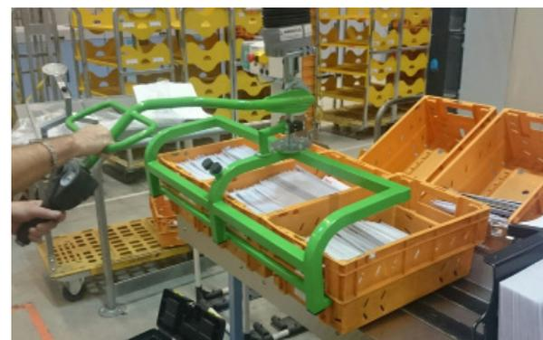
Vous **palettisez, dépalettisez ou transférez des bacs** pouvant atteindre jusqu'à 50kg à une fréquence importante ? Nos solutions d'aide à la manutention permettent de manipuler vos charges en protégeant l'opérateur.
