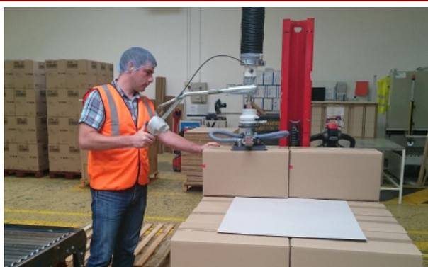
Vous **palettisez, dépalettisez** des charges légères sur une ligne de production à **une cadence importante** ? Nos systèmes d'aide à la manutention Light Lift Ergo permettent de réaliser ces manipulations afin de protéger l'opérateur.
